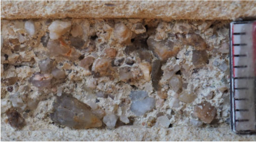
46. ← Mortier de remontage du pignon vers 1900, à gauche dans le joint de la figure 20 page 6. A droite tout près de la mire on distingue un reste de mortier de jointoiment, très similaire mais avec un sable plus fin. P9124120
