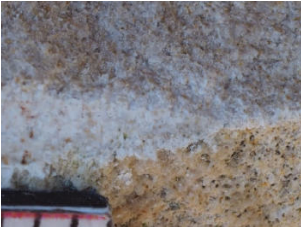
20. ↑ Grandeur nature, cassure fraîche du prélèvement. On remarque la désagrégation de la pierre au-dessus. P9124029
