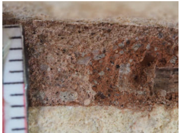
45. ↑ Détail grossi cinq fois environ, ce mortier est très différent des mortiers de tuileau plus anciens des figures 34 à 40, il contient 6% de gypse (ajout de plâtre ? Ciment naturel ?) P9164911
