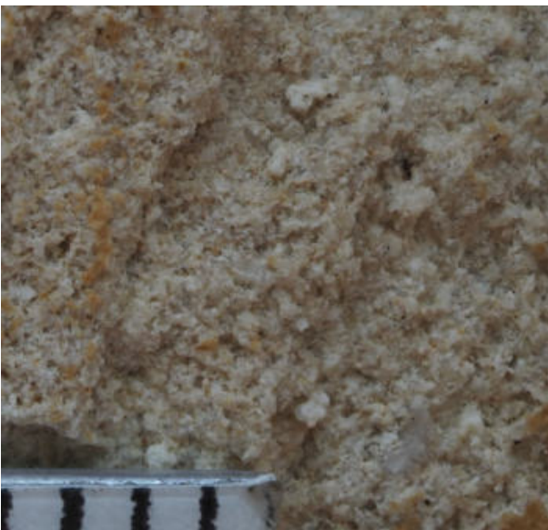
80. ↑ Détail tout en bas au centre figure 78, grossi dix fois environ ; on distingue les petites formations de sels blanchâtres P9165015
