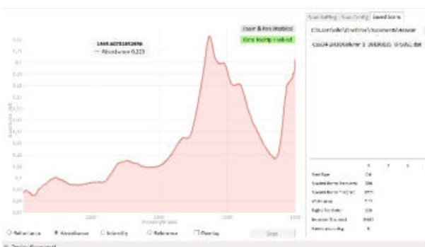
54. ↑ Acquisition d'un spectre proche infrarouge sur le joint de la figure 52. 20220913_135417
