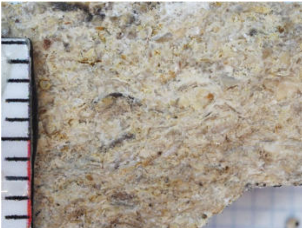
24. ← Grossie dix fois, cassure fraîche du prélèvement : calcaire bioclastique à grain relativement fort. P1211967
