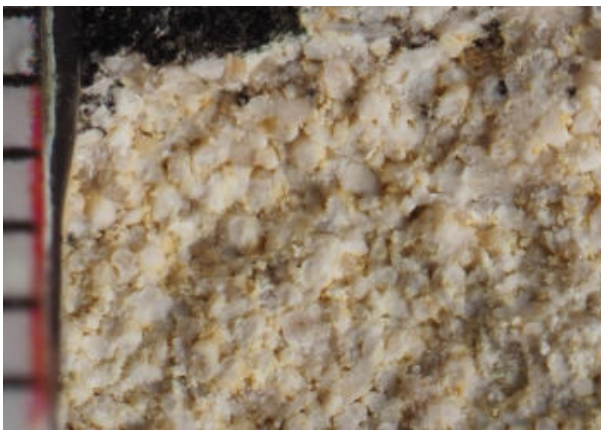
17. ↑ Détail grossi dix fois de la cassure fraîche à gauche figure 16 : calcaire oolithique plus tendre que celui de la figure Erreur ! Source du renvoi introuvable. P9124206
