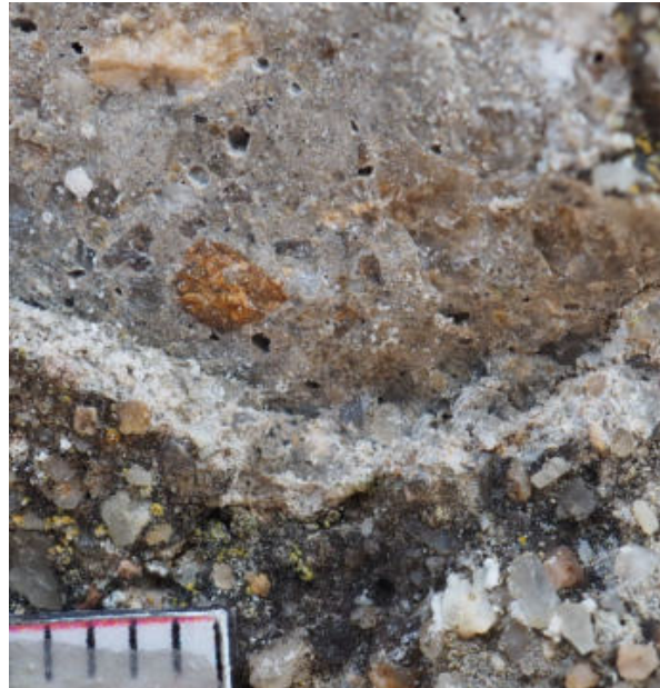
48. ↑ Détail grossi cinq fois environ. Malgré leur dureté, les grains de silex sont traversés par la cassure, ce qui témoigne de la dureté du liant. P9124088
