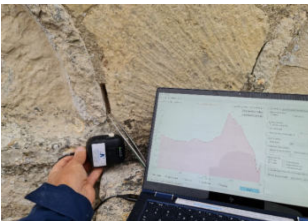
60. ↑ Identification de plâtre en bas à droite du relief central (fragment prélevé dans le joint et posé sur le spectromètre) 20220915_094041
