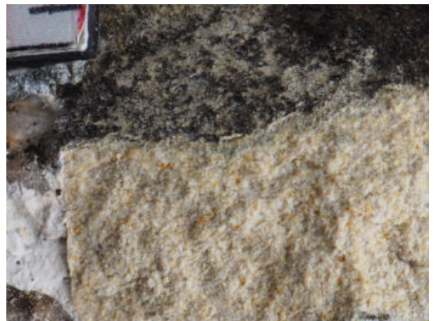
18. ↑ Détail grossi dix fois de la cassure fraîche à droite figure 16 : pierre de Charly P9124224
