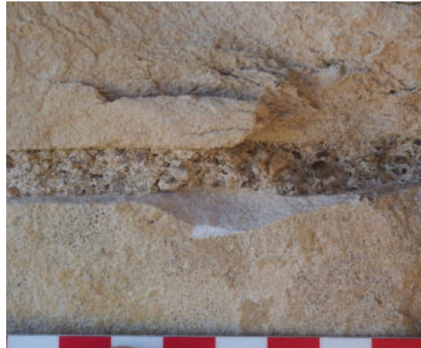
20. ↑ Grandeur nature, cassure fraîche du prélèvement. On remarque la désagrégation de la pierre au-dessus. P9124029
